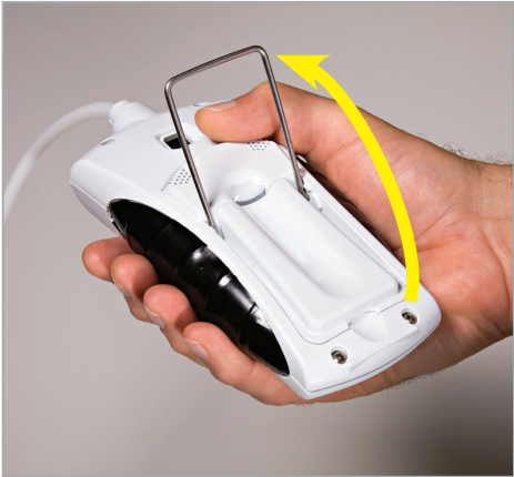
Figura 2: Sollevare il supporto prima di aprire lo sportello del vano batterie.
