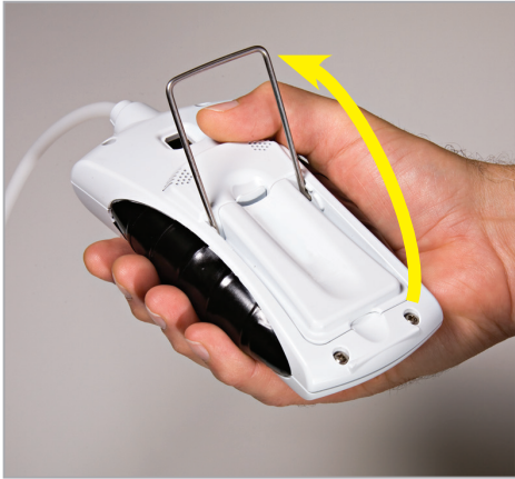
Abbildung 2: Klappen Sie den Drahtbügelständer voll auf, bevor Sie die Batterieklappe öffnen.
