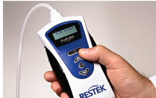
Abbildung 5: LED zeigt den gemessenen Flusswert an.
