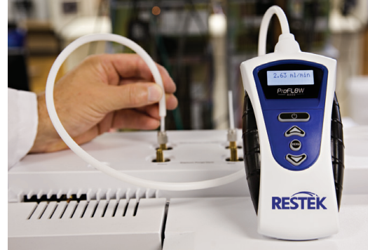
Abbildung 5: LED zeigt den gemessenen Flusswert an.
